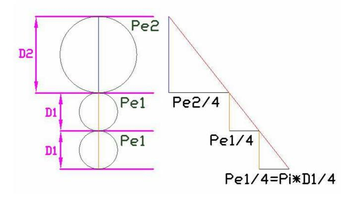
Asimismo, un cilindro de diámetro igual al de la rueda y de una cierta altura, sobre el que se fuera enrollando ordenada y apretadamente un cordel, nos permitiría obtener cordeles de una longitud igual a **n** vueltas de rueda (tantas como vueltas enrolladas), validos para marcar el terreno o realizar comprobaciones.
